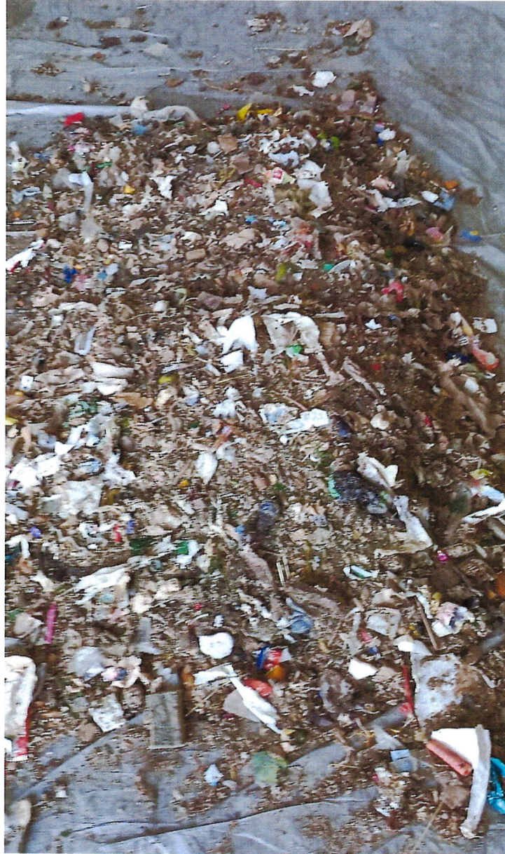
Obr. 11: První podsítná frakce (oka 40 mm)
