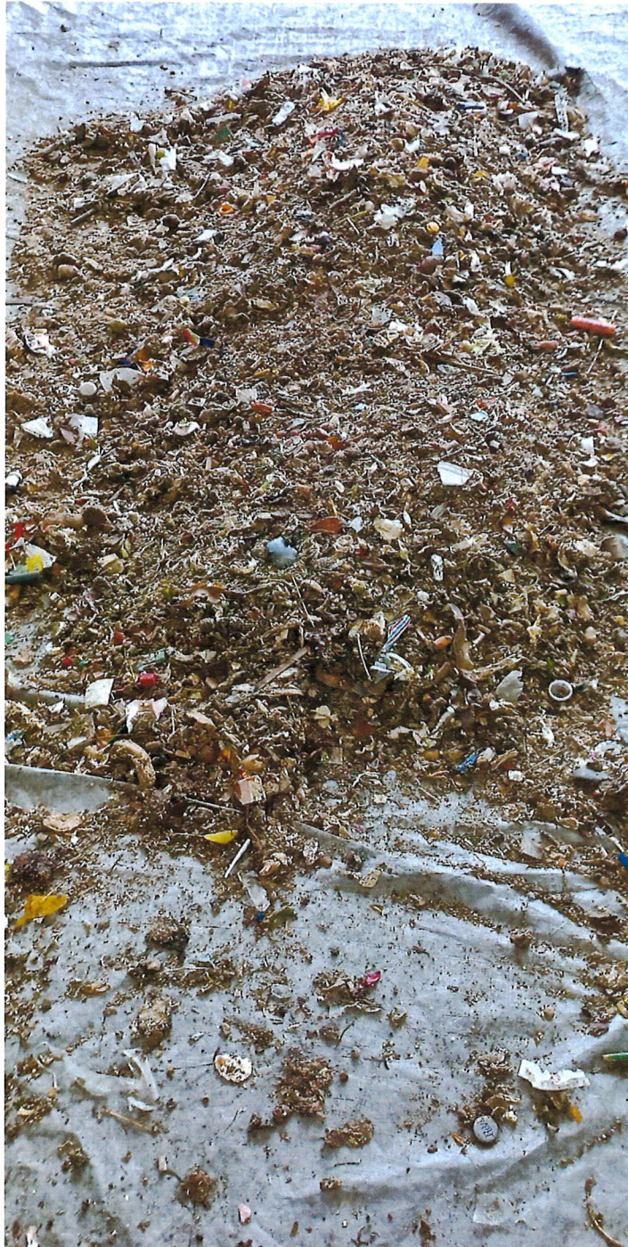
Obr. 12: Druhá podsítná frakce (oka 15 mm)
